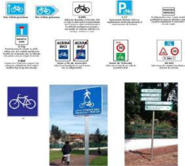
Ilustración 51. Ejemplos de señalización vertical para ciclistas.
